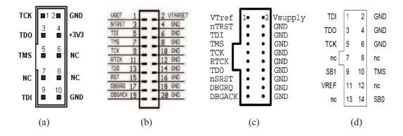
Figure (4.5) Shows JTAG connectors (a) Altera, (b) Xilinx, (c) Atmel, (d) Actel
