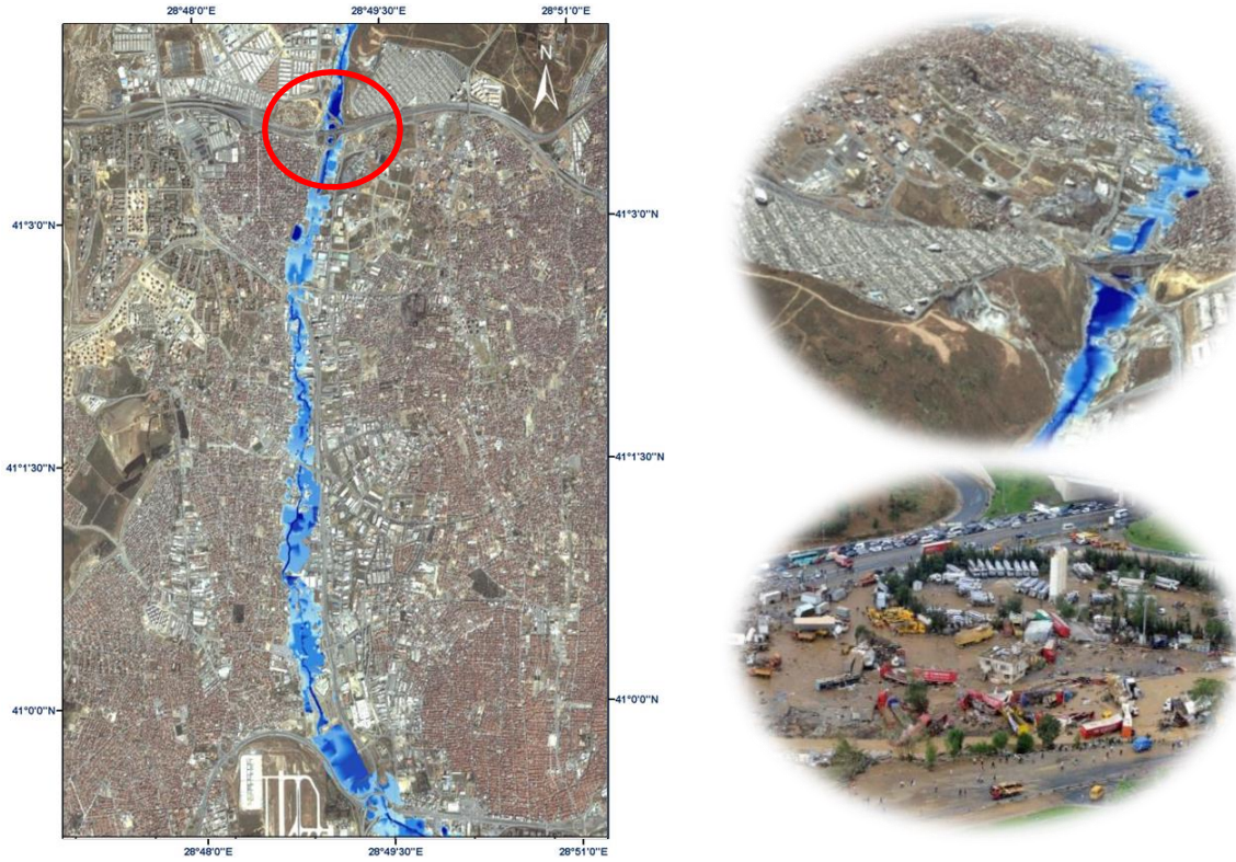
Şekil 6: Modelleme sonucu taşkın alanlarının SPOT 5 uydu görüntüsü üzerinde gösterimi (solda ve sağ üstte) ve 09.09.09 tarihinde gerçekleşen taşkının nehir yatağı ile TEM bağlantı noktasındaki TIR parkına etkisi (sağ altta)
