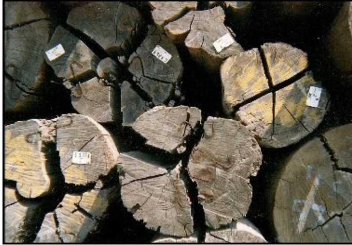
Şekil 1. Uzun süre depoda bekletilmiş tomruklarda oluşan derin çatlak ve yarıklar (Foto: R. Kantay).
