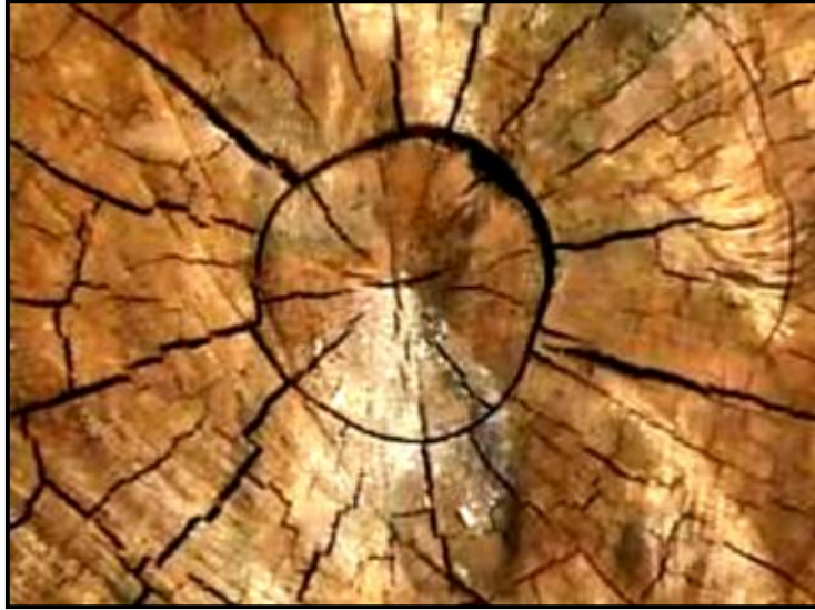
Şekil 2. Esmer çürüklüğe uğramış bir tomruk enine kesiti (Foto: Anonim).
