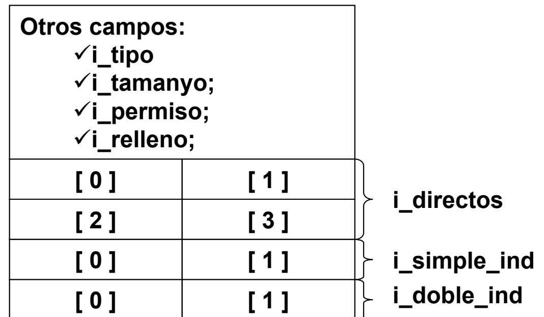
Estructura de un inodo
