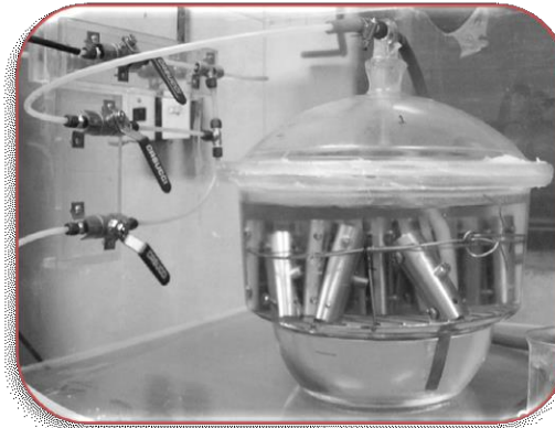
Corrosión bajo tensiones
