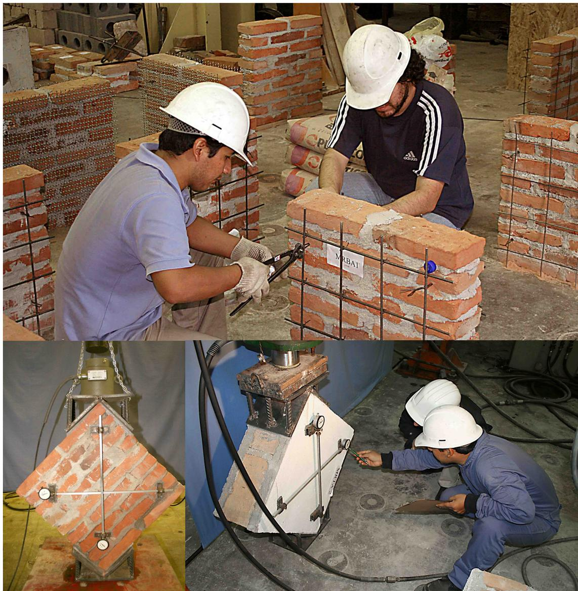
**Fotografía 19. Armado y ensayo de muretes reforzados con malla de acero y mortero proyectado en el Laboratorio de Estructuras del Instituto de Estructuras de la UNT.**
