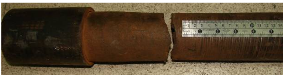
Figura 2. Extremo del tubing donde se produjo la fractura. Se aprecia una estricción del tubo en la región de fractura.
