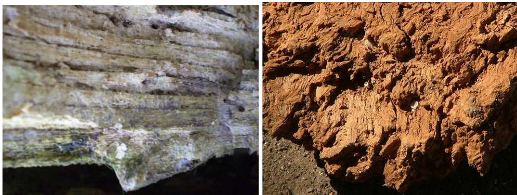
Figura 8 - Madera afectada por pudrición blanca.
