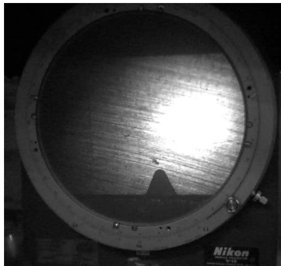
Figura 3 - 1.18.- Verificación de la geometría de la entalla de la probeta de Charpy-V por medio de un proyector de perfiles
