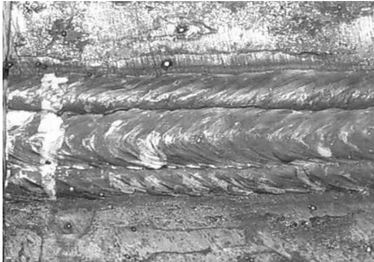
Figura 4 - 1.1.- Último cordón de soldadura de la probeta H3A (Ar + 5 %He)
