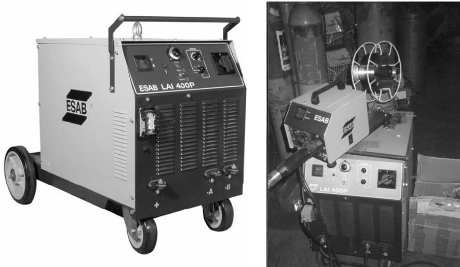
Figura 3 - 1.3.- Fuente para soldadura semiautomática y cabezal alimentador utilizados
