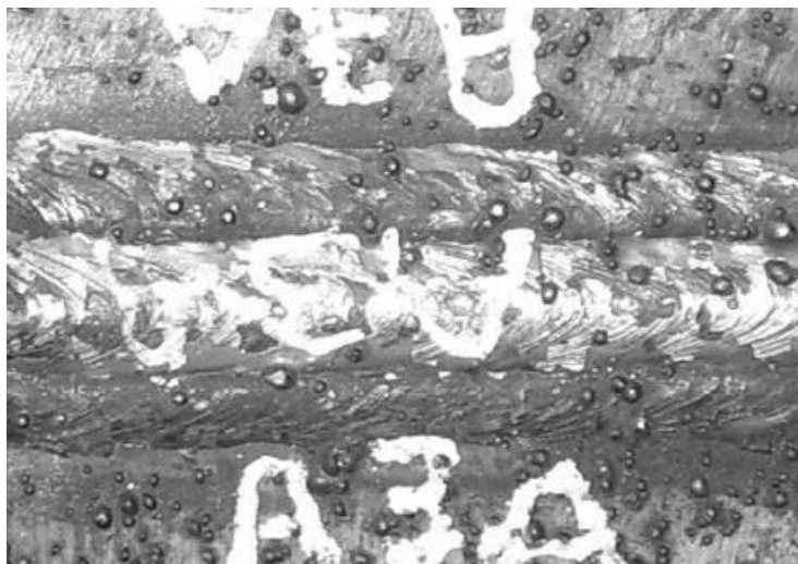
Figura 4 - 1.3.- Último cordón de soldadura de la probeta A3A (Ar + 18 %CO 2 )
