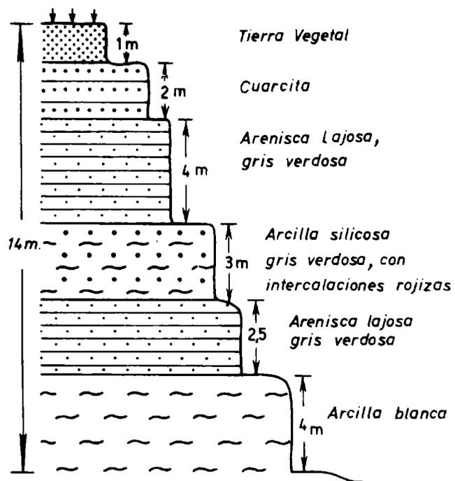
Fig. 1 Perfil de una cantera en mina " Barker "
