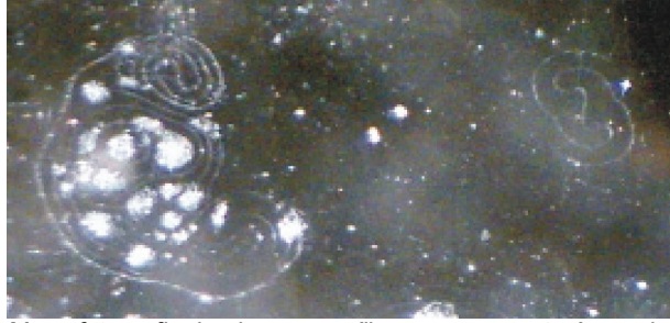
FIGURA 11 - Macrofotografia de obra em acrílico que apresenta áreas degradadas pela despolimerização. Fonte: FRANÇA, 2008
