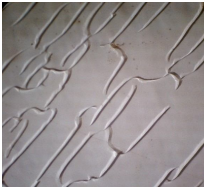
FIGURA 9 - Macrofotografia de obra em acrílico que apresenta Crazing tipo "L" - mosaico direcional. Fonte: FRANÇA, 2008
