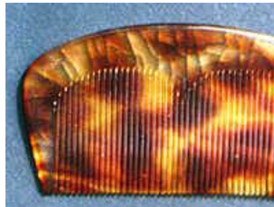
FIGURA 6 – Crumbing em peça de acetato de celulose. Fonte: http://www.plastiquarian.com
