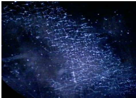
FIGURA 3 – a) Cracking em estado inicial.
