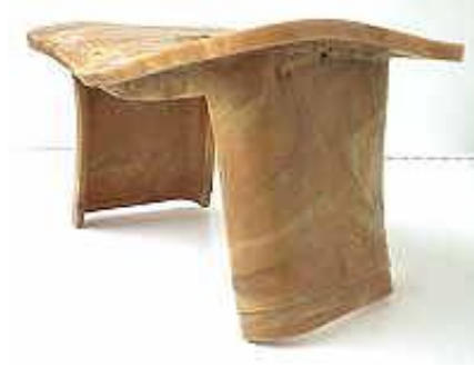
FIGURA 2 – Distorção causada pela migração do plastificante.
