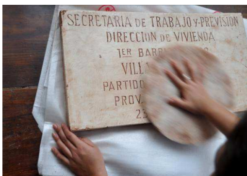
Figuras 13 y 14. Reproducciones realizadas con cemento blanco y fibras de polipropileno. Pátina fina, protección filmógena y obtención de brillo.
