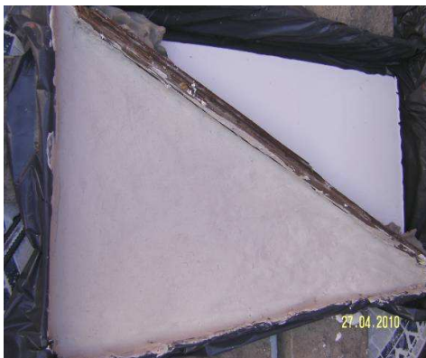
Figuras 11 y 12. Contra molde realizado en yeso y molde de caucho de silicona.
