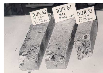
Figura 11. Influencia de la saturación del hormigón en su resistencia a la congelación
