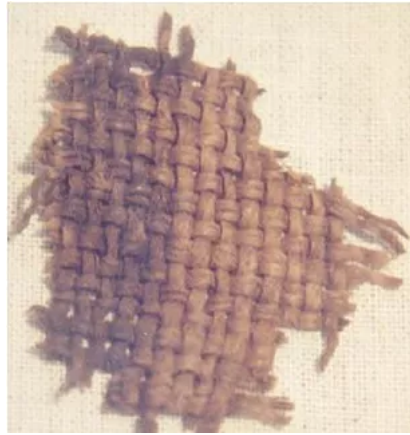
Limpieza parcial con láser de un fragmento de cáñamo, realizada en el Laboratorio de Ablación, Limpieza y Restauración con Láser, del Centro de Investigaciones Ópticas.
