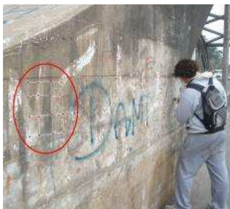
Imagen 16. Esclerometría, esquema de determinaciones.
