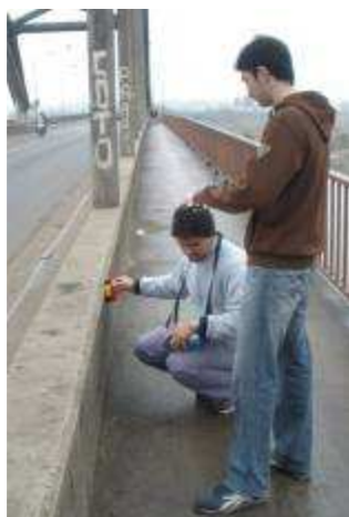
Imagen 15. Determinación de espesores de recubrimiento.
