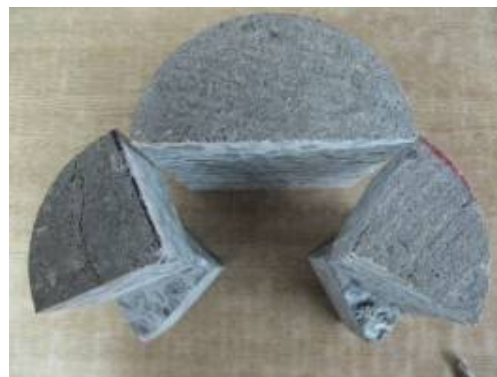
Figura 1. Obtención de muestras para estudios petrográficos y determinación de propiedades físicas, contenido de álcalis y composición de los hormigones
