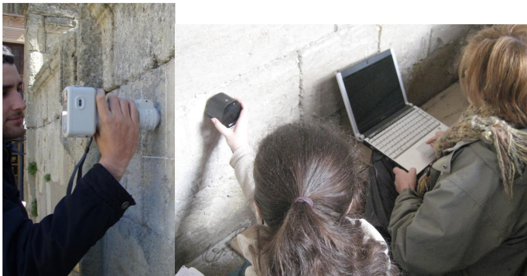
Figura 4 – Izquierda: espectrofotómetro. Derecha: rugosímetro óptico
