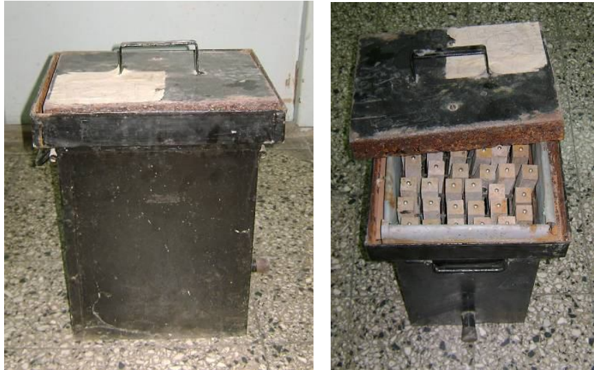
Figura 2. Contenedores de almacenamiento utilizados para el ensayo IRAM 1637 y detalle del cierre hidráulico
