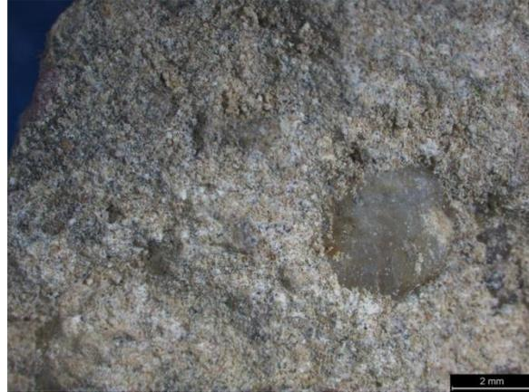
Figs.18 y 19. Vistas mesoscópicas de la junta / asiento de ladrillos M3. El material es más fino y, en comparación con los revoques, más homogéneo en composición. Presenta variaciones de color y puede englobar clastos aislados de arena natural (cQtz).
