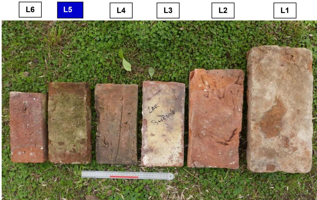
Fig. 26. Ladrillos y dimensiones relativas. Regla 30 cm (línea roja 10 cm).
