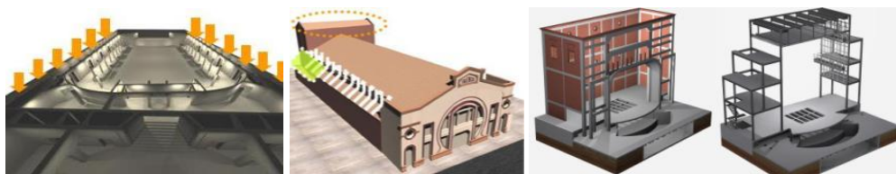
img. 19 Detalle de ubicación de las pantallas adosadas a los muros originales, estas se construyeron en concreto a la vista y se logra evidenciar la intervención dentro de los parámetros de originalidad de los espacios. Fuente: imágenes 3d de la propuesta, diarios de trabajo y bitácora de obra.
