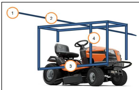
Fig. 4. 1) Cámara gran angular luz visible 2) Cámara multiespectral 3) Cámara luz visible para video 4) Unidad de control.
