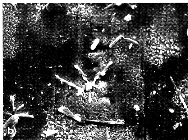
FIG. 6.— Morfología de la capa de inhibición frente a la velocidad de enfriamiento ( v_e ) para las muestras: a) A ( v_e = 5\text{ }^{\circ}\text{C seg}^{-1} . \times 2.500 ), y b) D ( v_e = 22\text{ }^{\circ}\text{C seg}^{-1} . \times 2.500 ).
