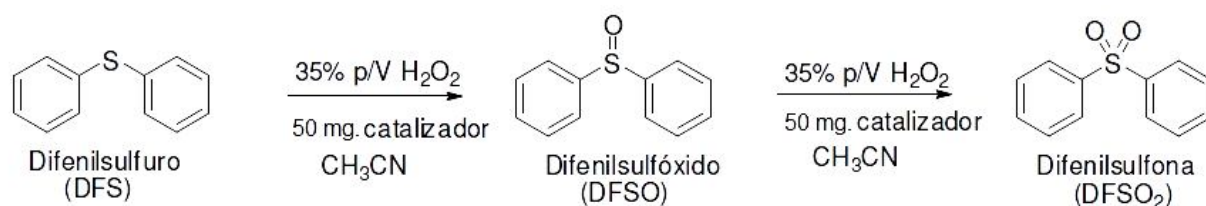
Esquema 1. Oxidación selectiva de DFS en presencia de H 2 O 2 y un catalizador heterogéneo.
