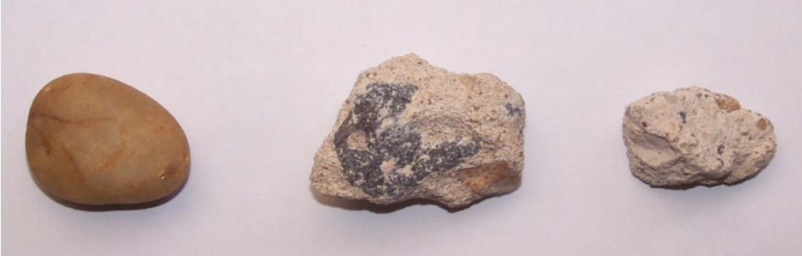
Estas características del agregado reciclado hacen que sea un material heterogéneo, constituido por dos fases: mortero y roca, que poseen propiedades diferentes; la porosidad del mortero es la más importante, ya que modifica otras propiedades como la densidad, absorción de agua, resistencia, dureza, durabilidad, etc.
