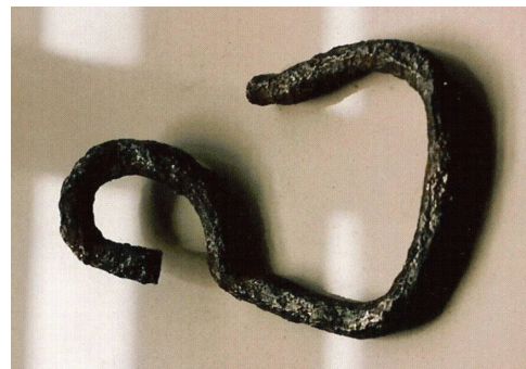
Gancho con corrosión y luego de la limpieza catódica
