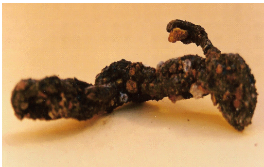
Trozo de cadena alterado por corrosión y luego de la limpieza catódica
