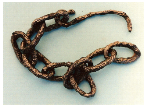
Trozo de cadena alterado por corrosión y luego de la limpieza catódica
