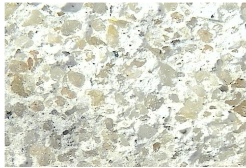
Microfotografía del mortero interno. Se observan granos de cuarzo en una matriz de color blanquecino
