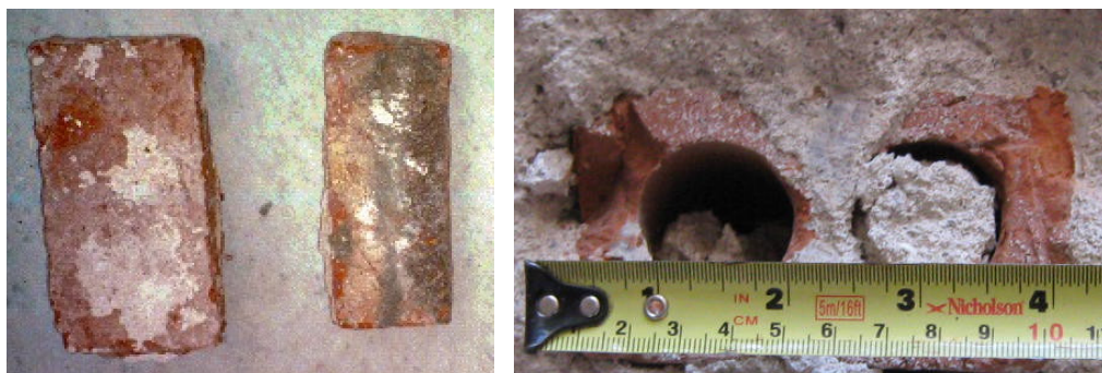
Figura 6 – Hotel Colón: ladrillos macizos y ticholos de dos bocas circulares.
