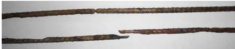
Figura 8.52: Barras de acero después de 110 días de ensayo (Serie 3).
