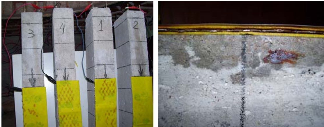
(a) (b) Figura 5.10: Vigas en ensayo (a) - Contraelectrodo y fisuras iniciales (b).
