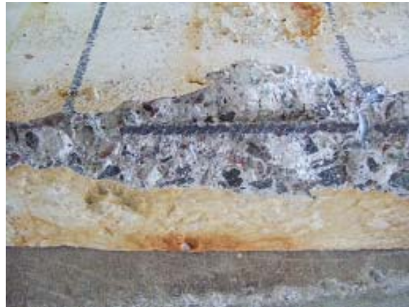
Figura 8.18: Barras corroídas extraídas de las vigas después de finalizado el ensayo (a), estribos corroídos (b) y armadura inferior no afectada (c).
