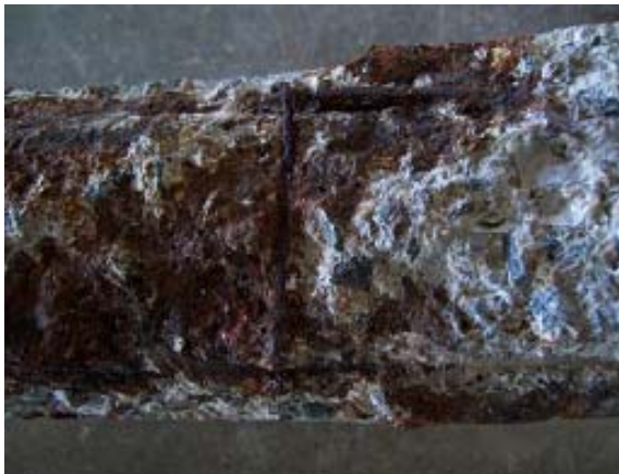
Figura 8.18: Barras corroídas extraídas de las vigas después de finalizado el ensayo (a), estribos corroídos (b) y armadura inferior no afectada (c).
