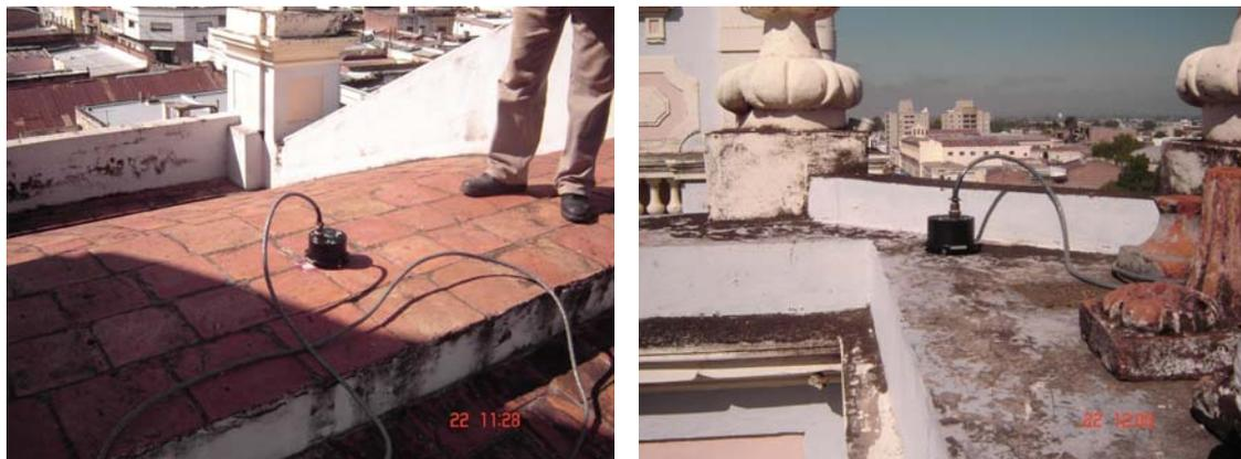
Figura 4: Acelerógrafos triaxiales [4]
