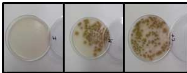
Figura 4. Crecimiento de A. Niger con biocida encapsulado en SBA-15: 560ppm de biocida (Izquierda), 280 ppm de biocida (centro), 140 ppm de biocida (derecha).
