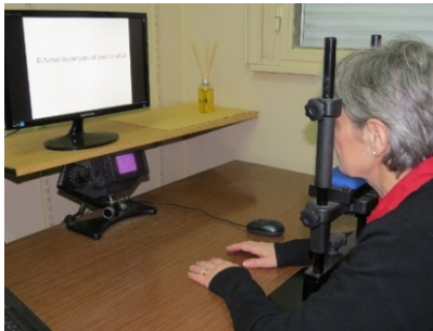
Figura 1: Proceso de registro de movimientos oculares. En la figura se aprecia una oración que aparece en el monitor, el eyetracker junto con el iluminador infrarrojo para aumentar el contraste de la pupila y facilitar su detección (por debajo del monitor) y la persona del grupo control leyendo la misma.
