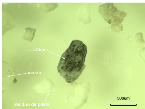
Figura 9: Matriz del revestimiento (residuo de la pasta), clasto lítico y de cuarzo del mortero del sustrato.
