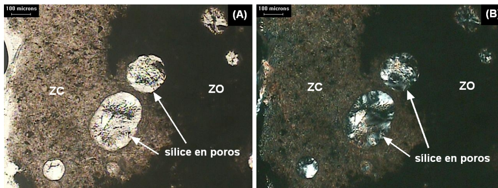
Figura 12: Se distingue una zona clara (ZC) y otra oscura (ZO) y sílice cristalina (esferas) taponando a los poros
