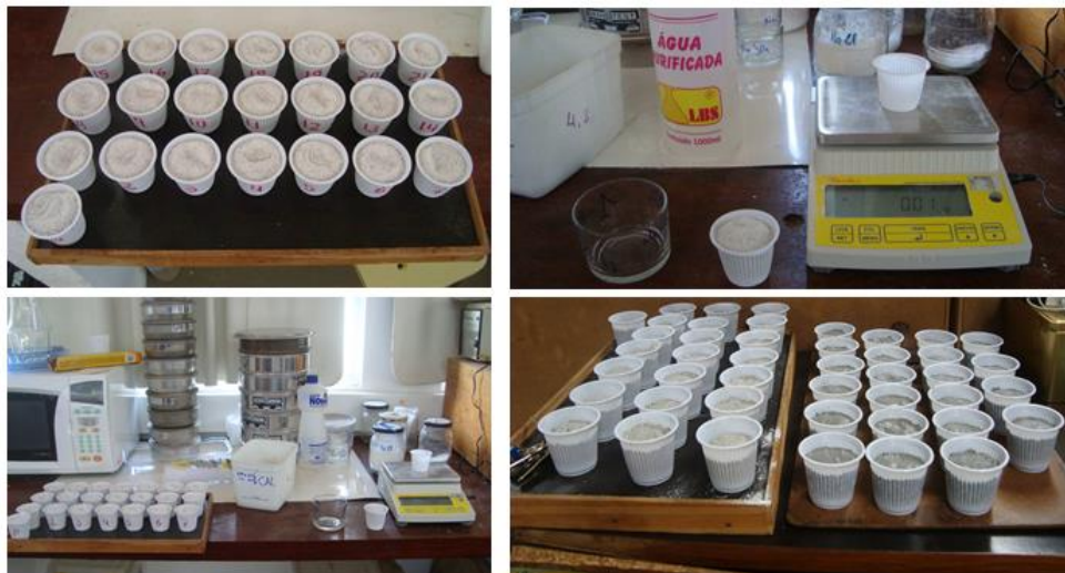
Figura 3: Confeção dos Corpos de Prova (Foto: Acervo Pessoal)
