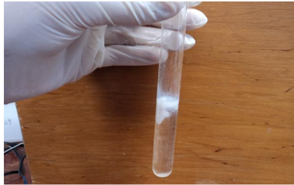
Figura 5: Determinação da presença de Cloreto (Foto: Acervo Pessoal)
