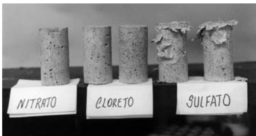
Figura 1: Visão geral dos corpos de prova à base de cal e areia, após uma sobrecarga de sais higroscópicos. Fonte: Nappi [1]
