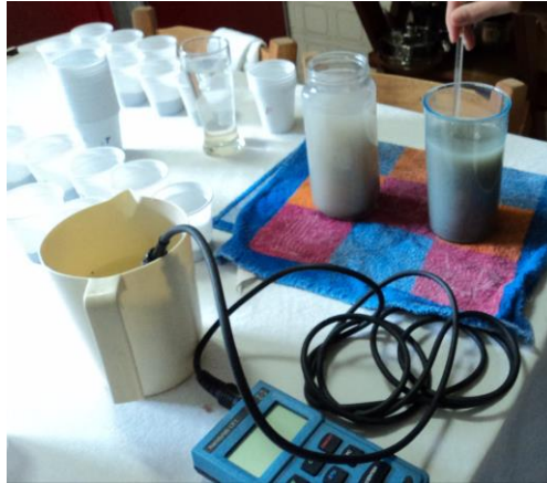
Figura 8: Leitura da corrente elétrica
