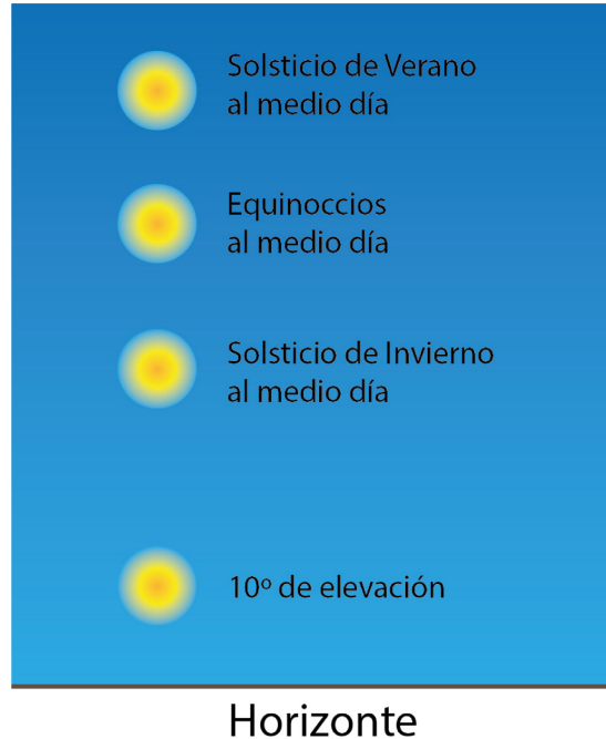
Figura 7. Diferencia entre las distintas posiciones solares utilizadas para el diseño del CCPI
