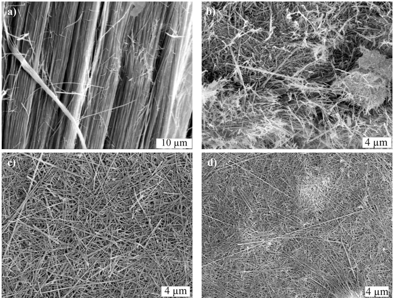
Figura 1: Micrografías SEM a) fibras naturales (20.000x), (b) gel de sepiolita original (10.000x), c) y d) gel de sepiolita con esfuerzo de corte (10.000x) y (5.000x) respectivamente.
