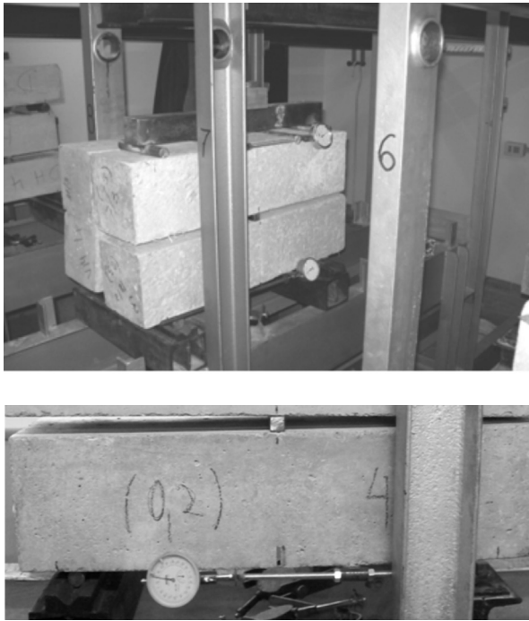
Figura 10. Aplicación de cargas de larga duración.
