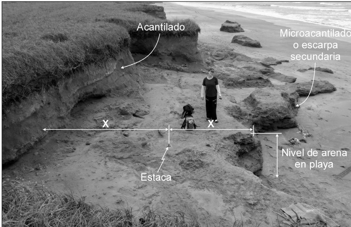
Figura 2: Medidas tomadas en el campo acerca del retroceso del acantilado y del microacantilado o escarpa secundaria, dado por el incremento de la distancia X y la disminución de la distancia X' , respectivamente.
