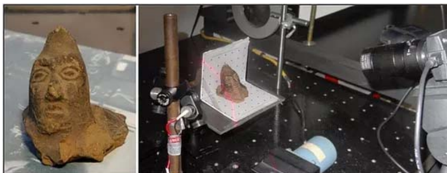
Figura 3. Izquierda: Escultura Pre-Inca peruana de terracota (5,2cmx4,6cmx4,2cm). Derecha: Configuración utilizada para escaneo con láser. Fotografía tomada en el LALRL-CIOp.
