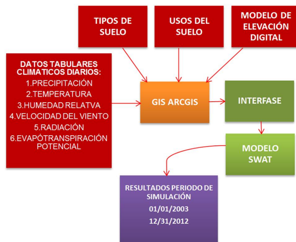
Figura 2 - Datos de entrada para simular procesos con el modelo SWAT
