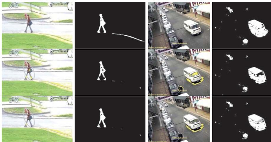
**Fig. 4.** Sustracción de fondo y detección de sombra. Imagen original (izq.) y Máscara resultante (derecha). Algoritmo ViBE (arriba). Algoritmo detección de sombras con NCC (centro) y Detección de sombras con algoritmo propuesto (abajo)
