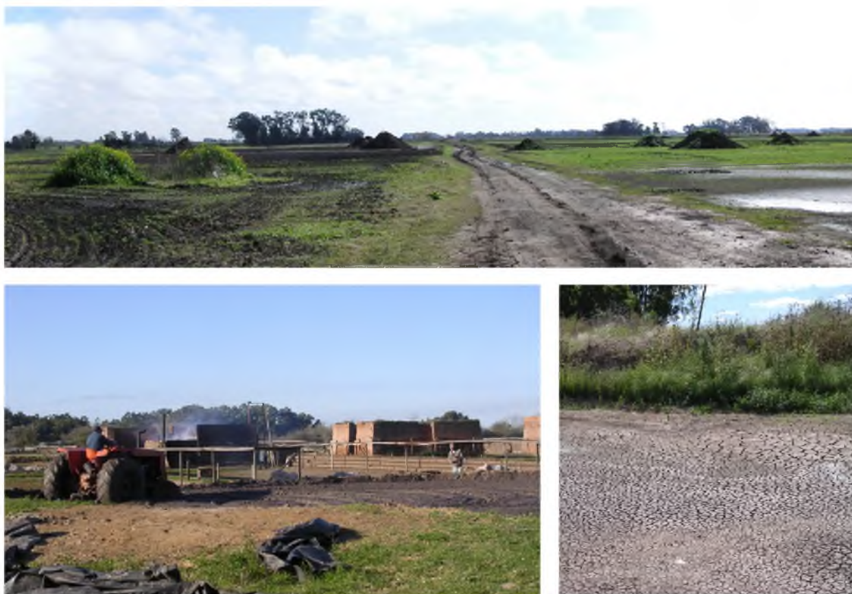
Fig. 36 - Decapitación, horno de ladrillos y horizonte arcilloso expuesto luego de la extracción del humus.
