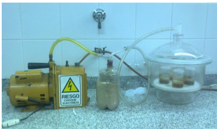
Figura 1. Dispositivo armado para realizar impregnación: este consta de una bomba de vacío y un disecador que actúa de contenedor para aplicar vacío del método.
