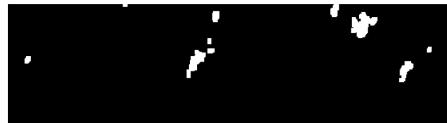
Fig. 7. Recorte binarizado y aplicadas operaciones de dilatación y erosión para quitar los elementos indeseados
