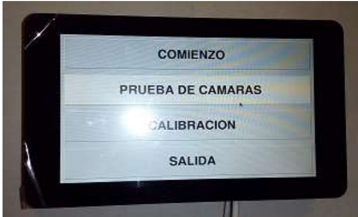
Fig. 14. Interfaz implementada sobre la unidad raspberry
