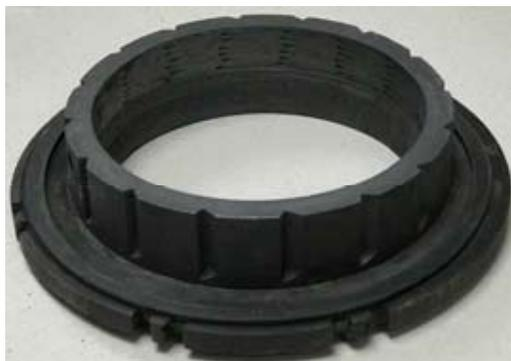
Рис. 3. Фотография токоподводящего электрода – завихрителя потока газа
