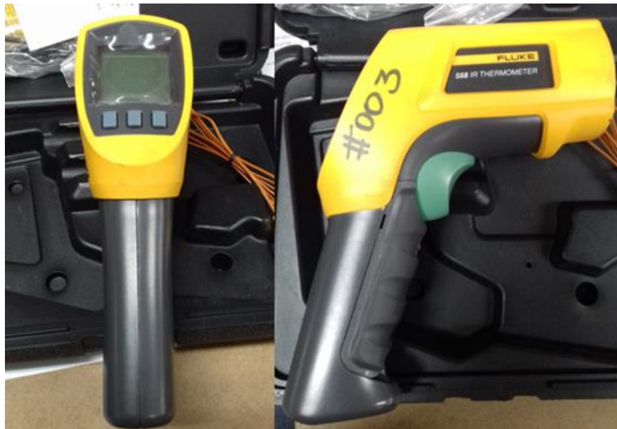
Figura 67. Termómetro infrarrojo Fluke® 568.
