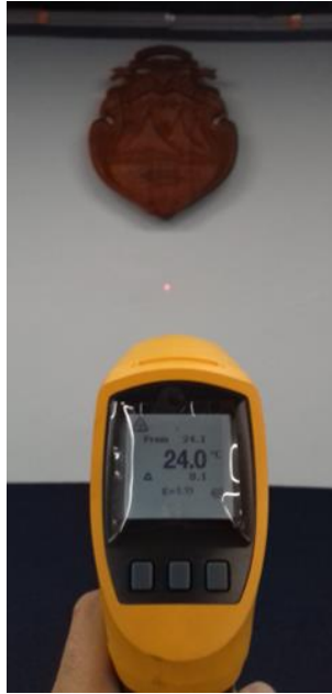
Figura 70. Medición de la temperatura en el interior del auditorio. Pared oeste.
