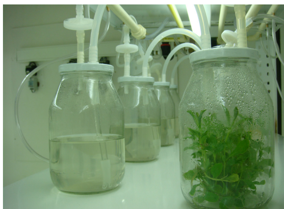
Figura 1. Sistema de inmersión temporal de vasos gemelos (BIT).
