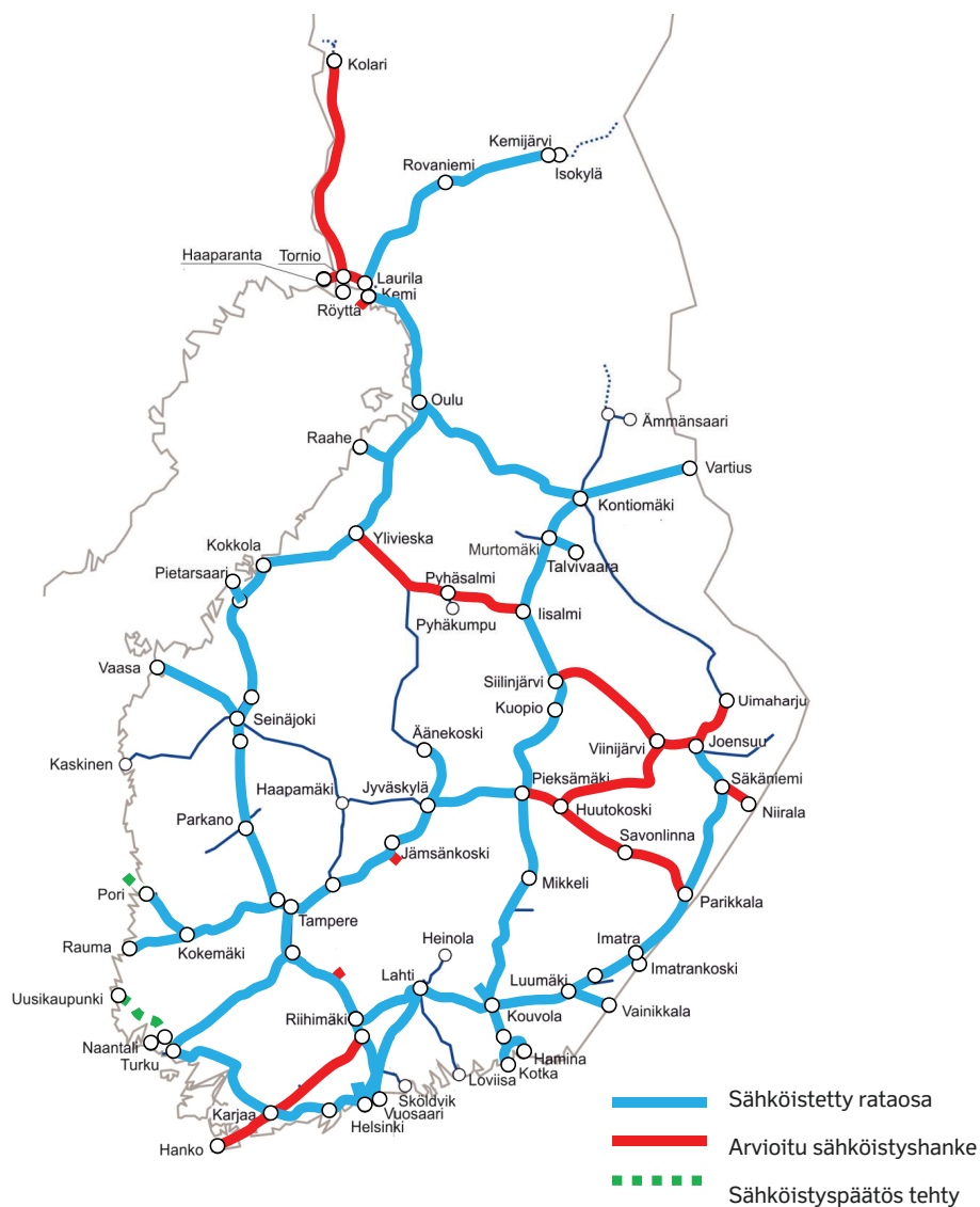
Kuva 11. Rataverkon sähköistyksen tilanne, sähköistettäväksi päätetyt rataosat sekä rataverkon jatkosähköistyksen arvioinneissa mukana olleet rataosat.
