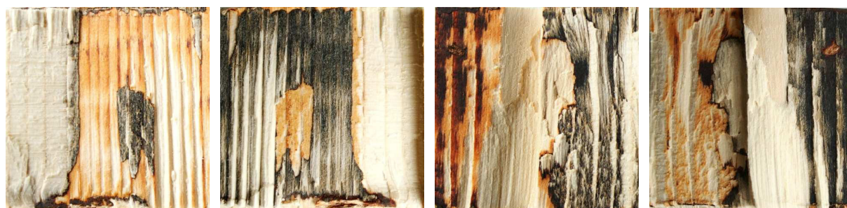
Figura 47: Exemplos do aspeto das juntas coladas com PRF após ensaio de corte.
