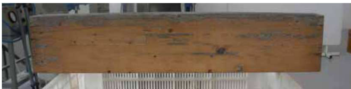
Figura 20: Aspeto de uma viga de madeira lamelada colada de Espruce com cola MUF com 30 meses de envelhecimento natural: a) Face sul, b) Face norte. (Gaspar (2010)).
