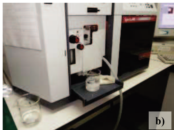
Figura 38: Espectrofotometria: a) Espectrofotômetro de absorção atômica por chama utilizado; b) Análise realizada a uma das amostras.
