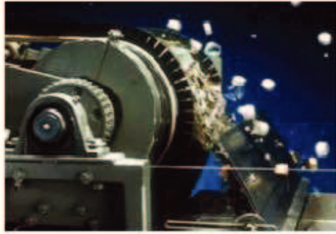
Figura 10: Funcionamento de uma máquina de corrente induzida.
