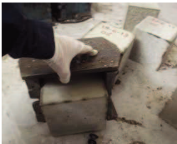
Figura 28: Desmoldagem dos cubos de betão.
