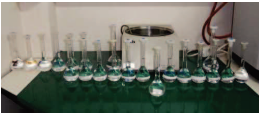
Figura 34: Padrões utilizados para a preparação das curvas de calibração dos metais.
