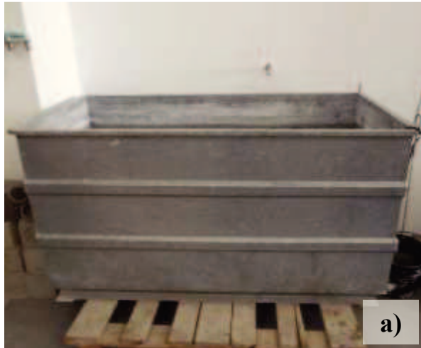
Figura 29: Cura dos betões: a) Tuba de água de cura; b) Provetes de betão submersos na água de cura.
