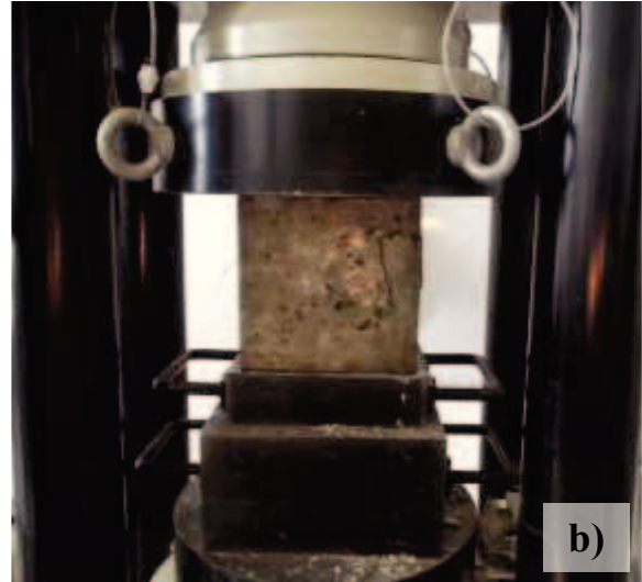
Figura 31: Execução dos ensaios de resistência à compressão: a) Colocação do provete no equipamento; b) Provete a começar a ceder às forças efetuadas pelo equipamento.
