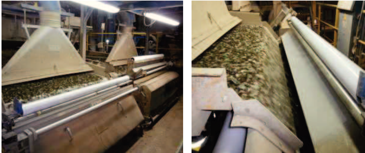
Figura 20: Máquinas de escolha ótica
