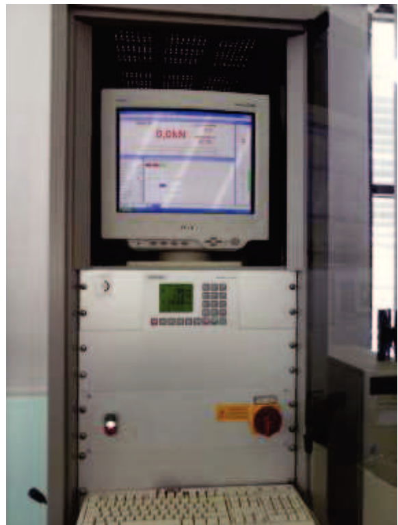
Figura 30: Equipamento utilizado para a execução dos ensaios de resistência à compressão dos betões.
