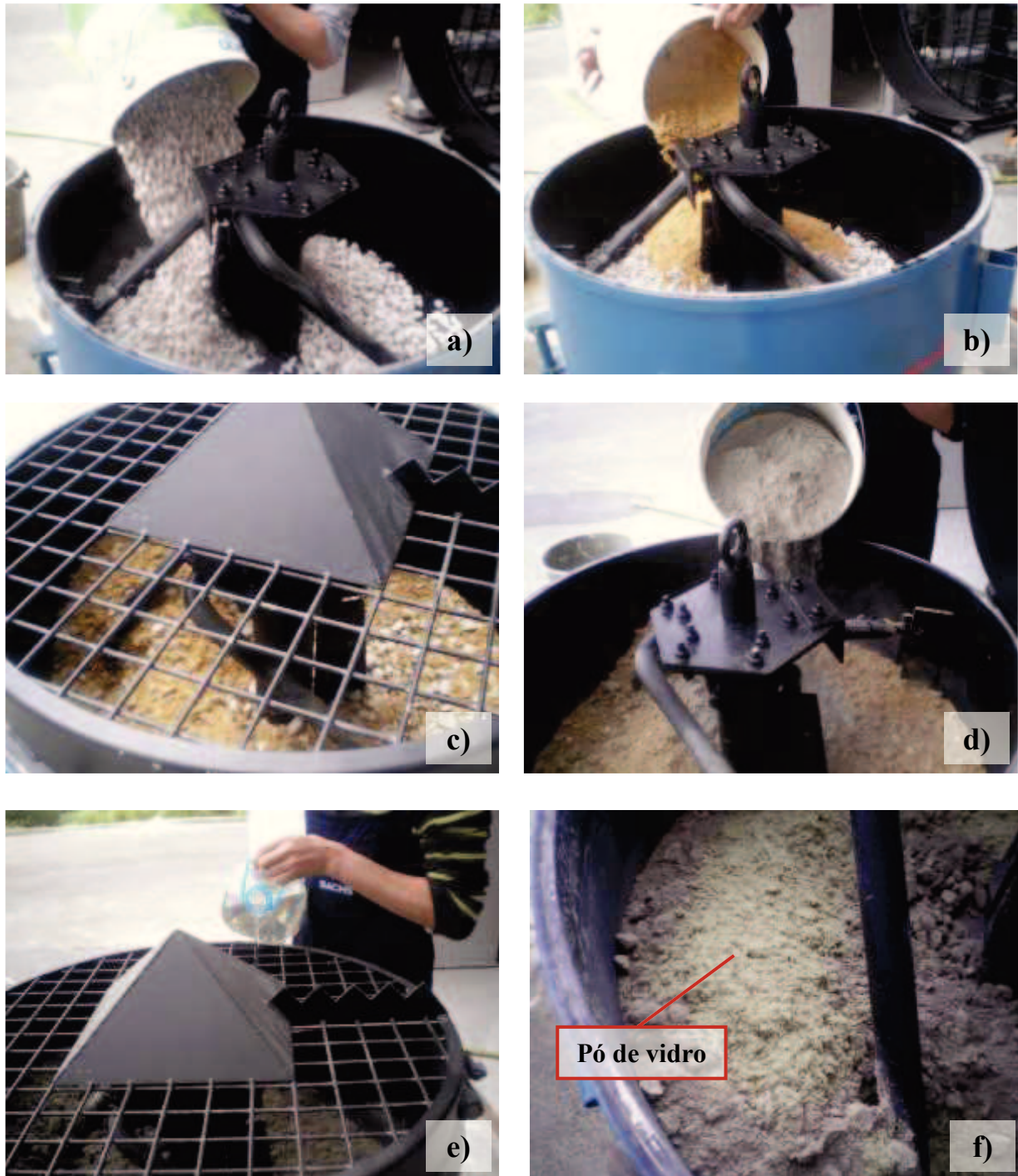
Figura 26: Produção dos betões: a) Adição de brita; b) Adição de areia; c) Mistura de agregados; d) Adição de cimento; e) Adição de água; f) Adição de vidro.
