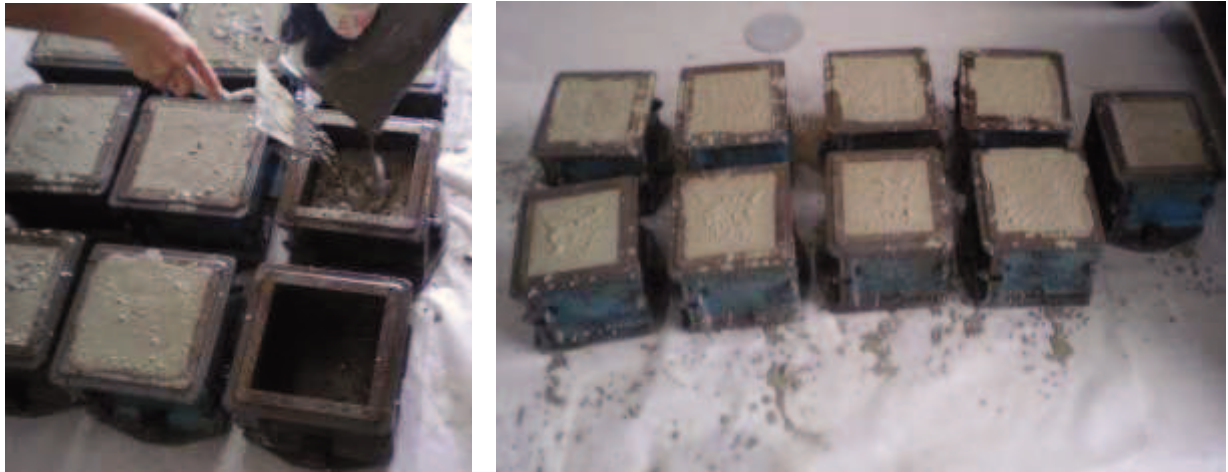
Figura 27: Moldagem dos cubos de betão.
