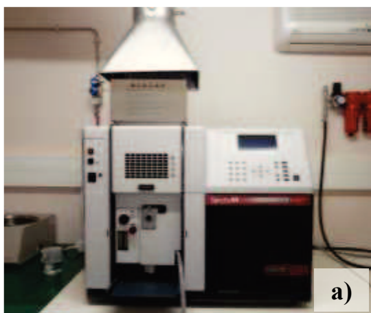
Figura 38: Espectrofotometria: a) Espectrofotômetro de absorção atômica por chama utilizado; b) Análise realizada a uma das amostras.
