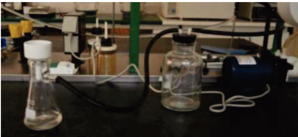
Figura 35: Equipamento usado para a filtração das amostras.
