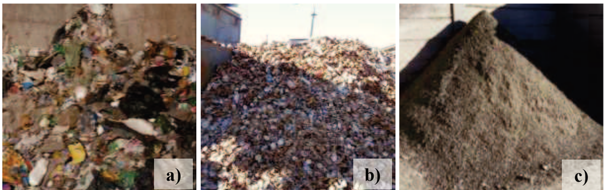
Figura 22: Resíduos resultantes do processo de reciclagem do vidro: a) Resíduos leves (papéis, plásticos, etc.); b) Resíduos ferrosos; c) Resíduo das máquinas óticas (resíduo em estudo neste projeto)
