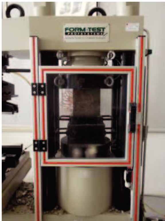
Figura 30: Equipamento utilizado para a execução dos ensaios de resistência à compressão dos betões.
