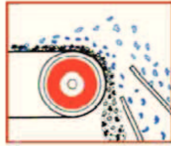
Figura 10: Funcionamento de uma máquina de corrente induzida.
