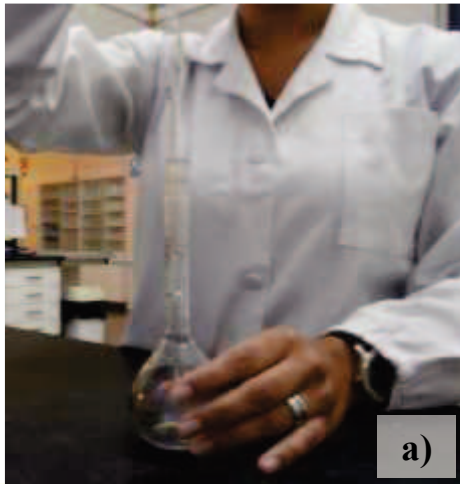
Figura 33: Preparação dos padrões utilizados para a preparação das curvas de calibração: a) Pipetamento dos padrões; b) Perfazimento dos padrões com água destilada.
