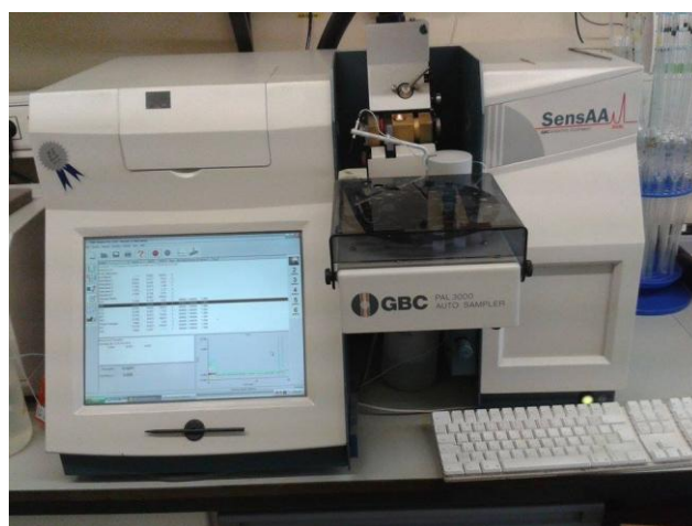
Figura 10 - Câmara de Absorção Atômica com atomização eletrométrica
