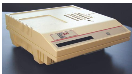
Figura 11 – Equipamento Microtox®, utilizado para a medição da luminescência da bactéria Vibrio fischeri
