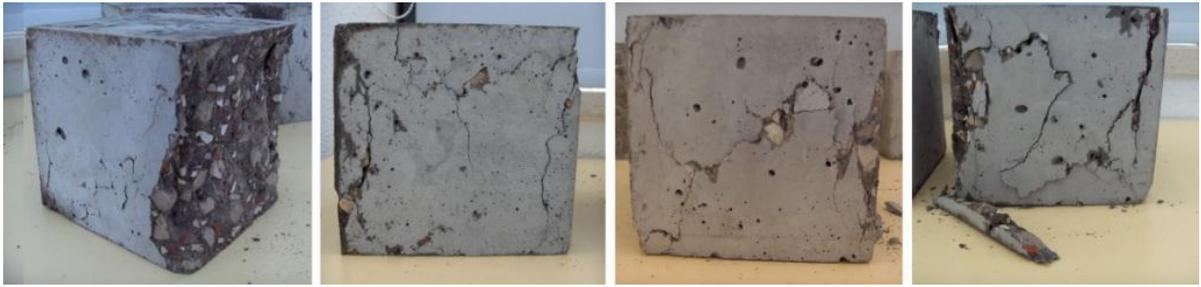
**Figura 3.18** – Provetes depois do teste de compressão
