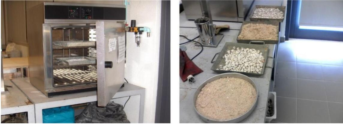
**Figura 3.12** – Estufa utilizada para a secagem do agregado
