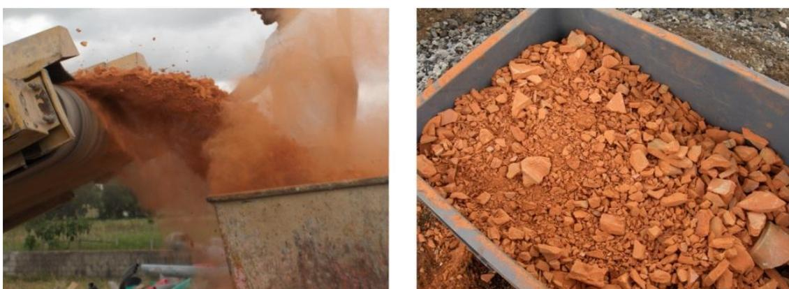
**Figura 3.5** – Material cerâmico reciclado britado a sair da britadeira
