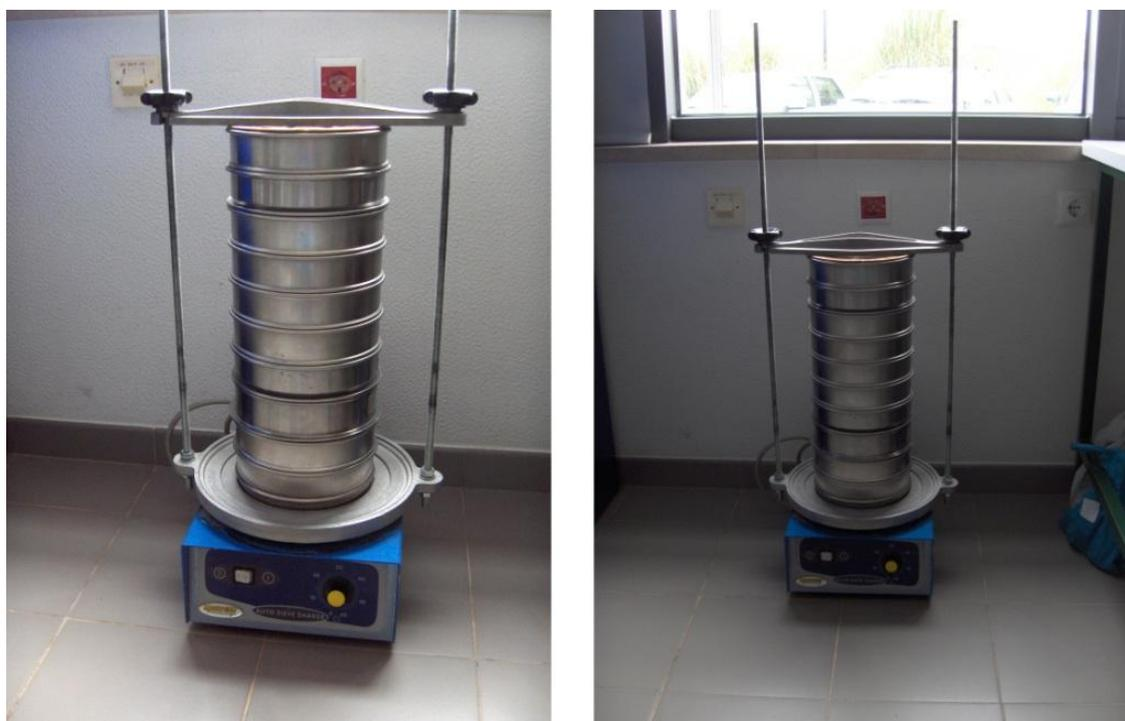
**Figura 3.9** – Peneirador mecânico do Laboratório de Geotecnia e Vias de Comunicação do I.P.Leiria
