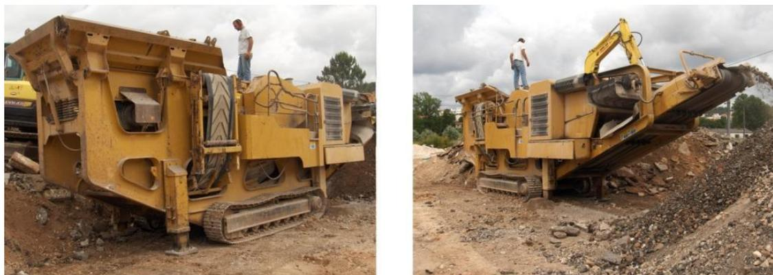
**Figura 3.2** – Britadeira utilizada para a britagem da telha
