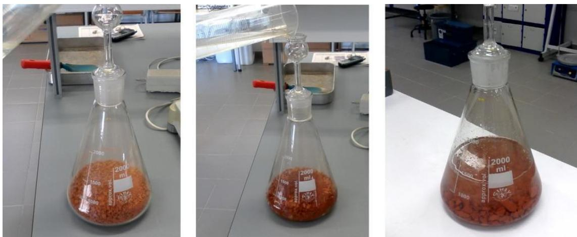
Figura 3.10 – Picnómetro com agregado submerso em água desmineralizada
