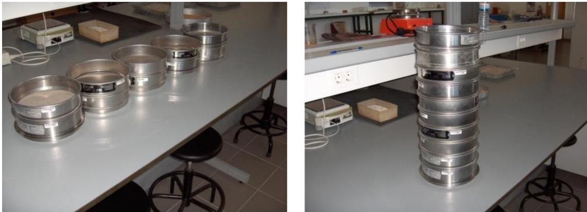
**Figura 3.8** – Peneiros utilizados na análise granulométrica
