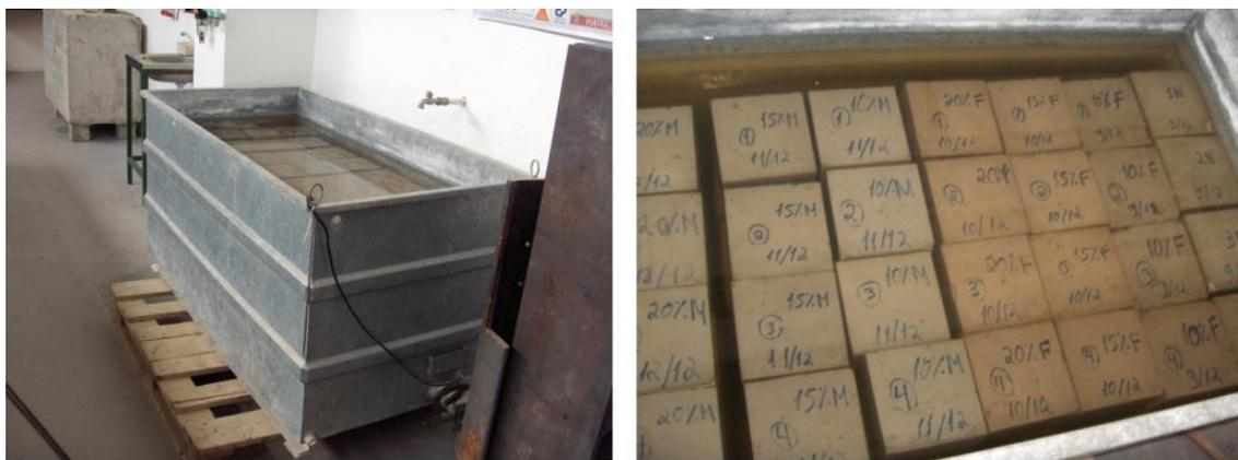
Figura 3.15 – Provetes submersos em tanque
